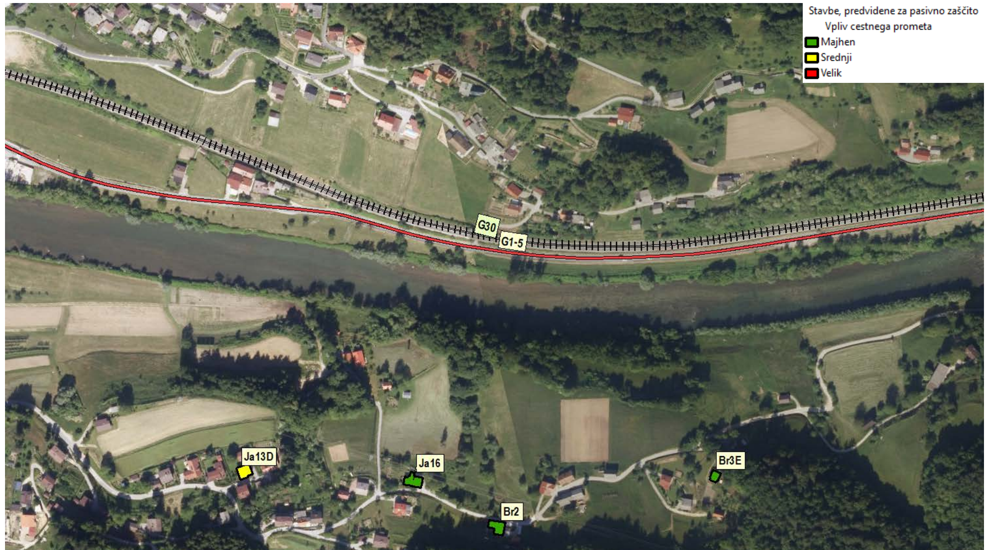
Slika 9: Stavbe predvidene za pasivno zaščito, stacionaža G30, od 518.410 do 519.430
